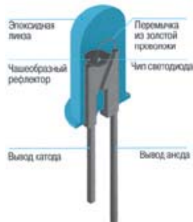
Рис. 1. Конструкция СИД фирмы Agilent Technologies
